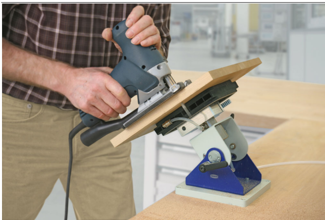
Multi-Clamp VC-M bei der manuellen Bearbeitung eines Holzwerkstücks
